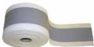
**CAMPO D'IMPIEGO** Realizzazione di giunti ad elevata resistenza in abbinamento ai sistemi impermeabilizzanti liquidi e cementizi della linea Gattofel WG o similari. Sigillatura di giunti di dilatazione di terrazzi, raccordi pavimento-parete, spigoli.
