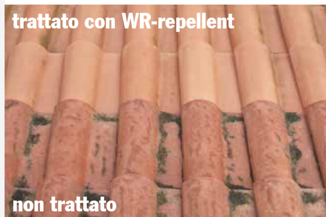
Test di invecchiamento di 36 mesi su tegole in cotto. (Centro Studi e Ricerche Gattocel)
